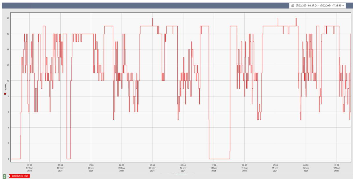
Figures 3 et 4 : Débit turbiné par la centrale de Montahut du 1/1/2021 au 31/12/2021 (axe Y de 0 à 18 m³/s) puis zoom sur la période du dimanche 7 au vendredi 12 février 2021
