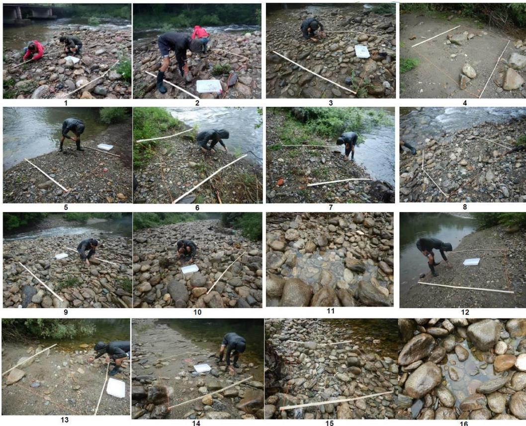
Station d'Ornac : relevés de la faune piégée-échouée suite à une éclusée de  $17,4 \text{ m}^3/\text{s}$  du 1 ou 2 juin 2021. Le débit de base le jour de la mesure est d'environ  $500 \text{ l/s}$  ( $490 \text{ l/s}$  à la station d'Olargues). Noter la granulométrie généralement grossière du banc, les flaques résiduelles parfois présentes, et les patches de substrats sableux.
