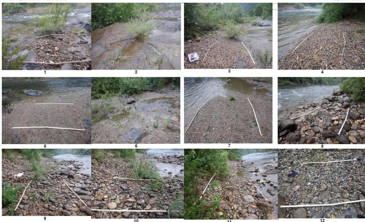
Station de Drouille : relevés de la faune piégée-échouée suite à une éclusée de  $17,4 \text{ m}^3/\text{s}$  du 1 ou 2 juin 2021. Le débit de base le jour de la mesure est de  $6,44 \text{ m}^3/\text{s}$  à la station de Vieussan (à l'aval immédiat). La flaque résiduelle n°6 a piégé 88% des invertébrés (et le vairon). Elle ne s'est pas asséchée (fond en partie rocheux).
