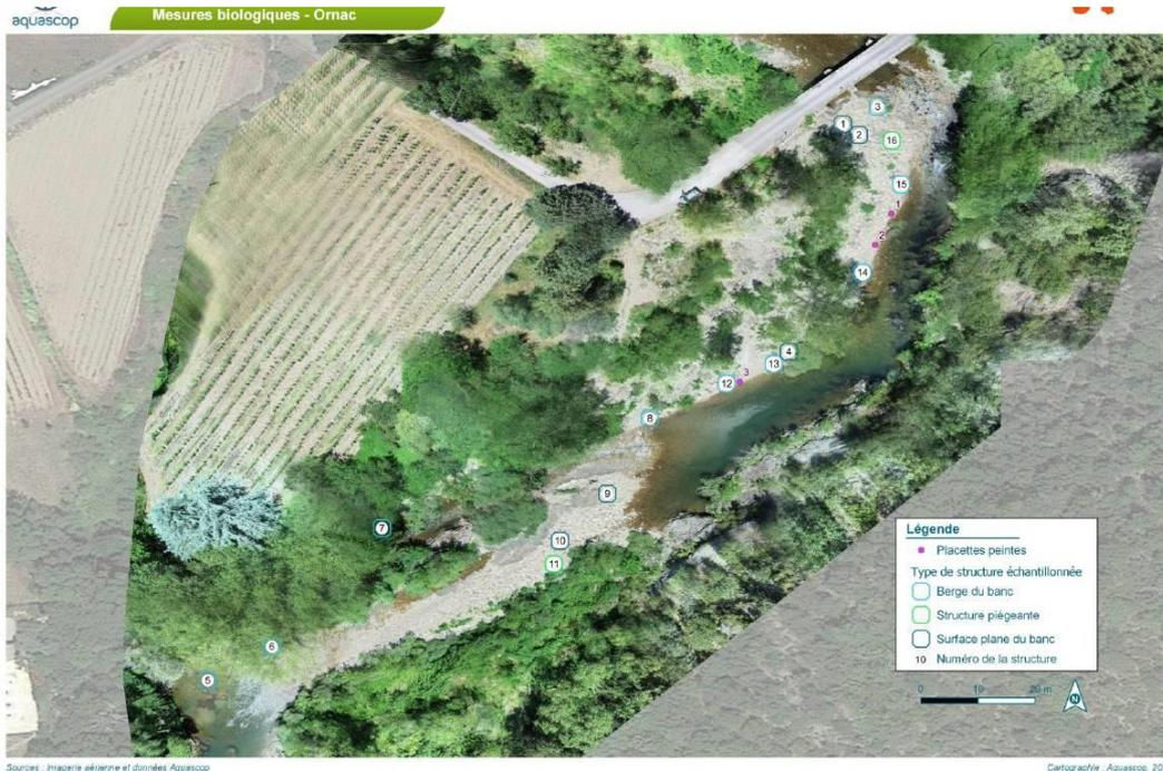
Station d'Ornac : relevés de la faune piégée-échouée suite à une éclusée de  $17,4 \text{ m}^3/\text{s}$  du 1 ou 2 juin 2021. Le débit de base le jour de la mesure est d'environ  $500 \text{ l/s}$  ( $490 \text{ l/s}$  à la station d'Olargues). Les numéros réfèrent aux placettes échantillonnées pour la biologie lors de la baisse de débit (voir photos ci-dessous).
