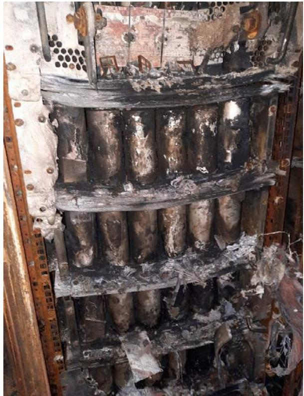
Photo 7 : Etat d'une armoire de condensateurs au milieu du container. Les condensateurs sont encore reconnaissables contrairement à la photo 6.
