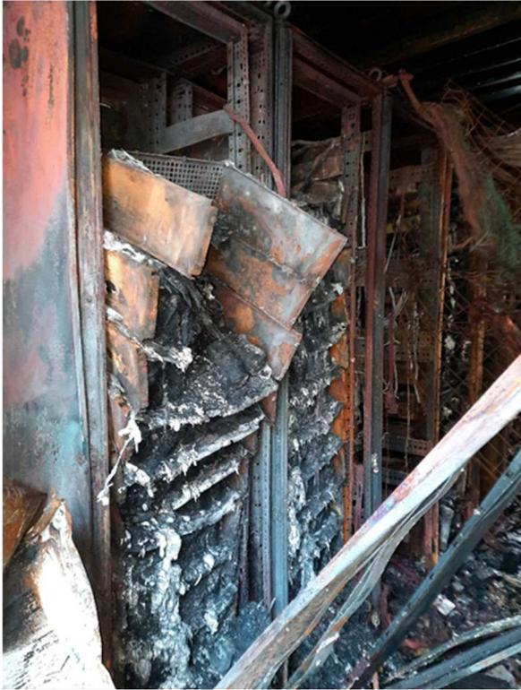
Photo 7 bis : rack de supercondensateurs détruits (Zone 1)
