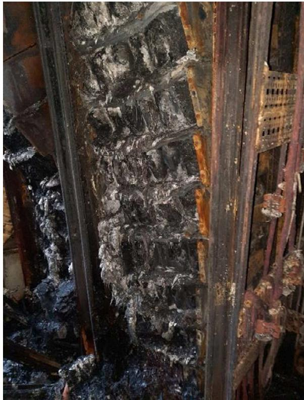
Photo 6 : Etat des condensateurs dans la zone 1. On constate une importante détérioration des composants électroniques.
