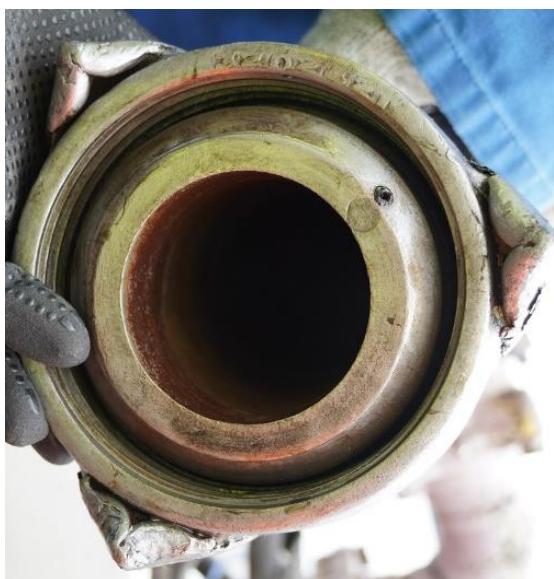
Photographie 1 : Écrou à frapper côté bras de chargement. L'orifice visible sur la périphérie du raccord sert au contrôle d'étanchéité à l'air comprimé
