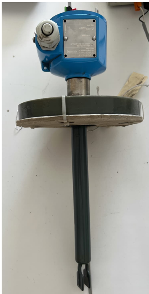
Photo 1 : Capteur de niveau fournit par SAIPOL pour tests complémentaires
