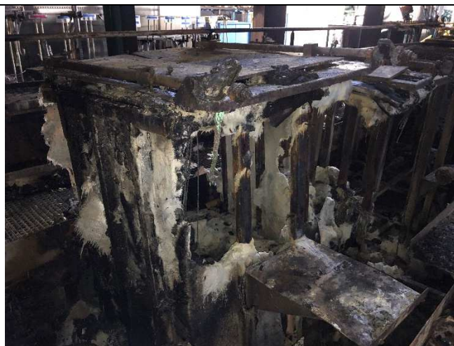
Photo 20 : Vue d'un baign d'acide ayant totalement fondu et ayant perdu sa solution
