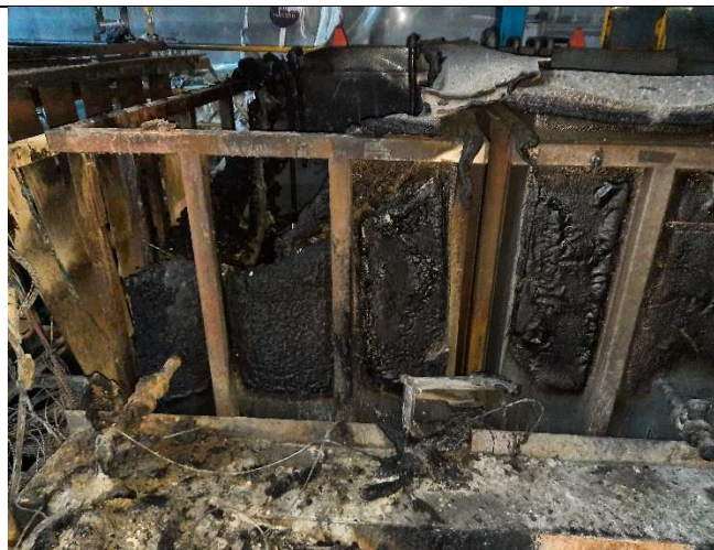
Photo 18 : Vue de la paroi carbonisée d'un baign d'acide
