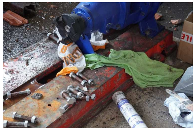
Photo 2 : Boulons retrouvés à proximité qui servaient à raccorder les deux brides entre elles.
