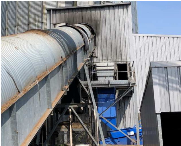
Vue du local crible par lequel pénètre le convoyeur à bande sous le carter
