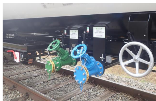
Figure 9 : Branchements phase liquide (en bleu) et phase gaz (en vert) (Crédit : LAT NITROGEN)
