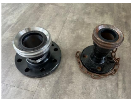
Figure 8 : Raccords phase liquide et phase gaz (Crédit : LAT NITROGEN)
