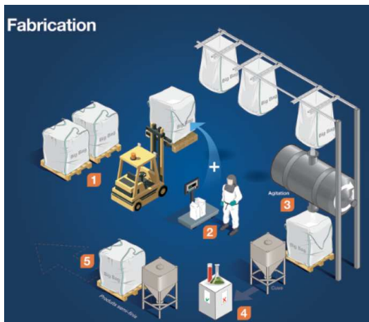
Figure 3 : Synoptique du process de fabrication (Source HYDRAPRO)
