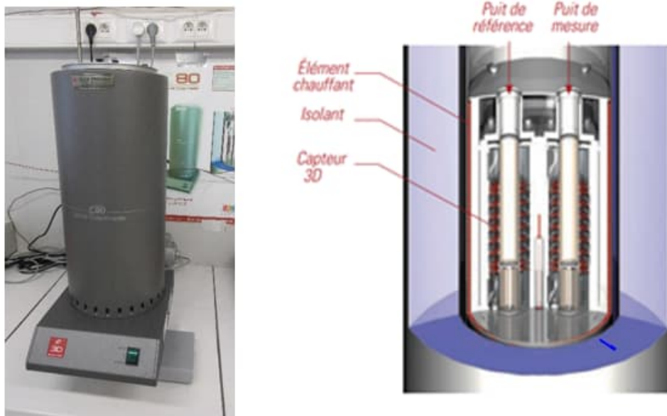
Figure 5 - Schéma et photographie du calorimètre Calvet C80
