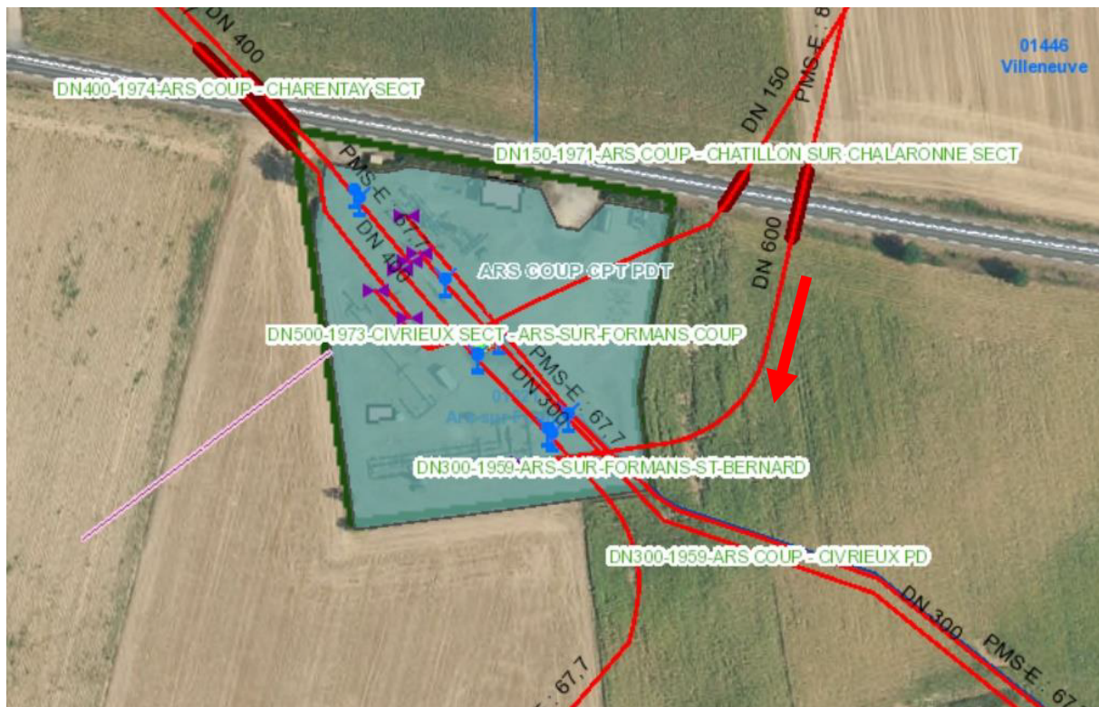
Figure 1 : La station d'Ars-sur-Formans et les différentes entrées et sorties de canalisations – la flèche rouge matérialise la canalisation DN600 en provenance de la station de compression de Châtillon-sur-Chalaronne
