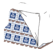
Stockage et protection des sacs palettisés.
