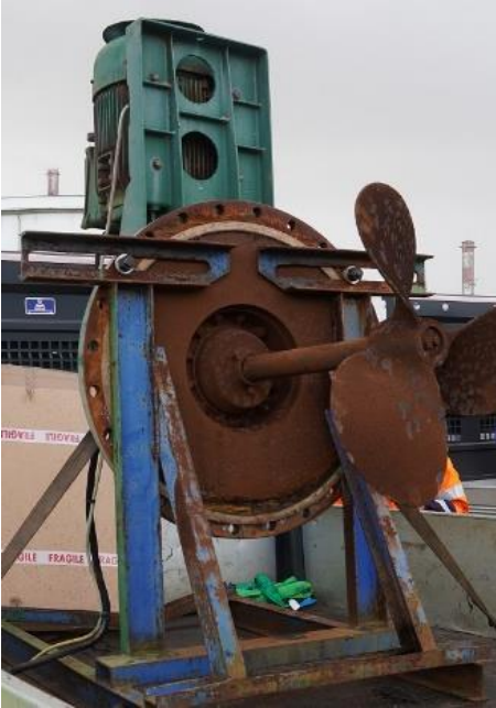
Figure n°2 : photographie de l'hélicomélangeur n°2 après sa dépose suite à la fuite survenue sur l'hélicomélangeur n°1
