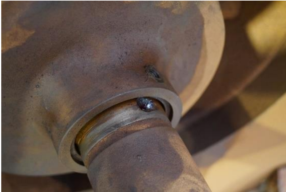
Figure 20 : arrachement de matière mettant en évidence le sens de rotation de l'hélice
