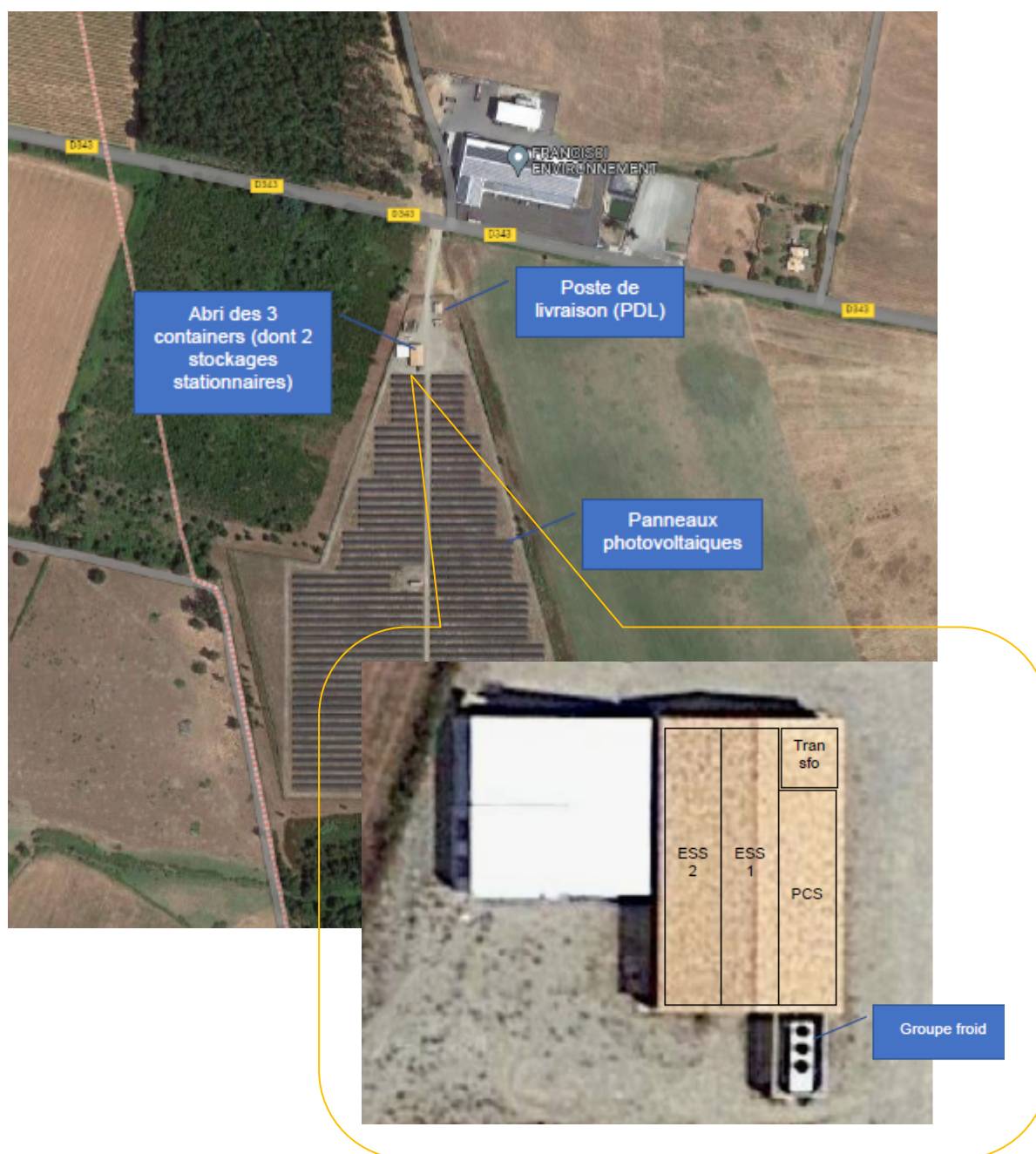
Figure 1: plan de situation de la centrale photovoltaïque d'Olmo et de ses deux conteneurs de stockage d'énergie électrochimique
