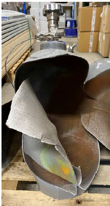
Figures 8, 9, 10, 11 : bouteilles éclatées ou déformées lors de l'accident
