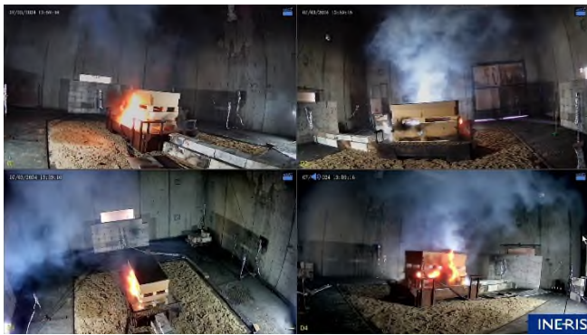
Photographie 29 : le feu gagne en intensité. Les flammes qui se forment ne sont pas caractéristiques d'un feu de métal mais correspondent à un feu de contenant
