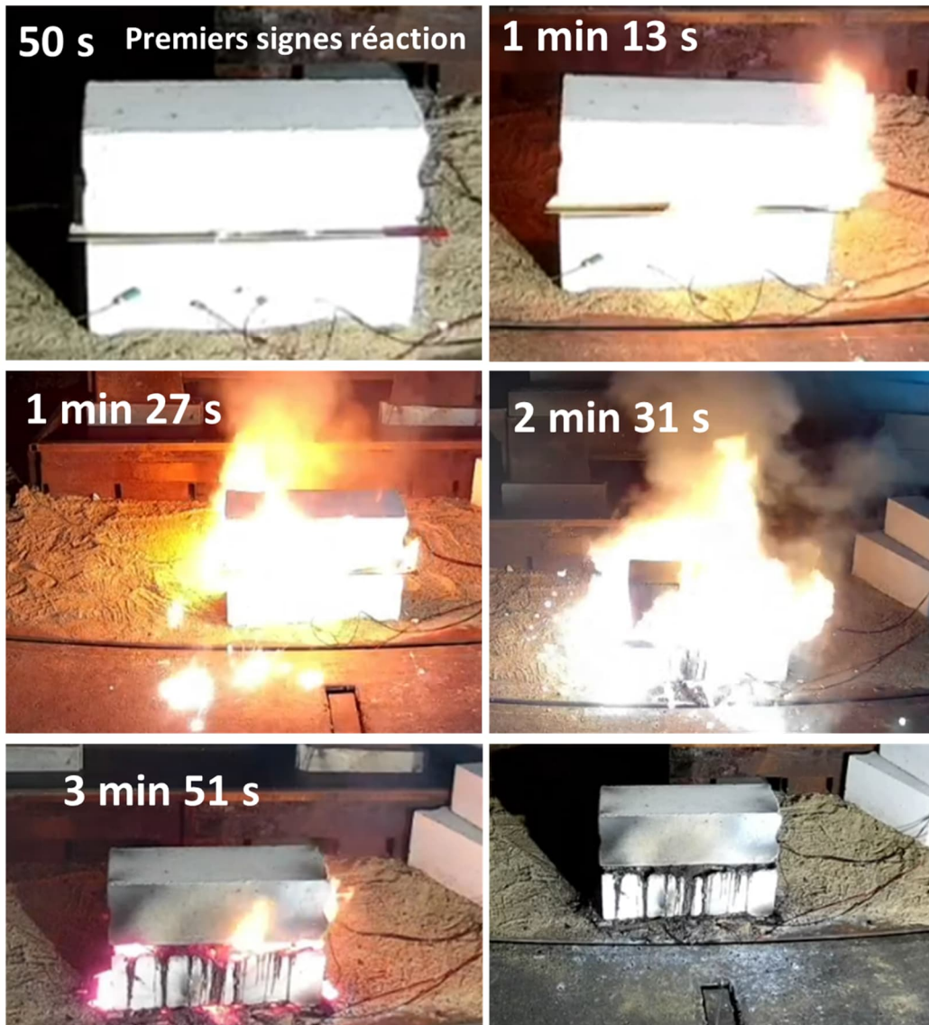
Figure 42 : Extraits vidéo de la seconde chauffe après remplacement du pad chauffant
