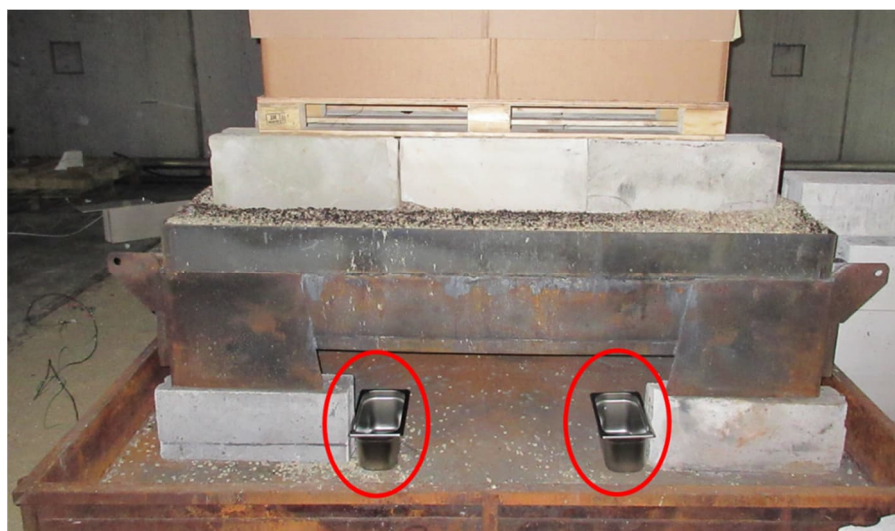
Figure 102 : Réceptacles de collecte des eaux d'extinction
