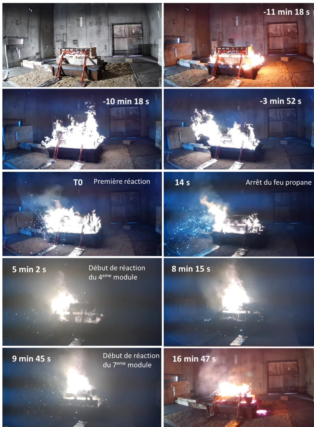
Figure 61 : Captures d'écran de la vidéo lors de l'essai feu caisse
