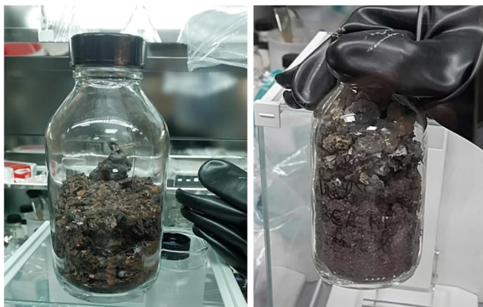
Résidus de l'essai de flux radiant
