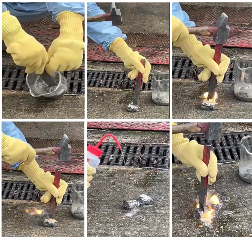
Figure 143 : Clichés photographiques du comportement de l'échantillon humidifié soumis à une action/contrainte mécanique
