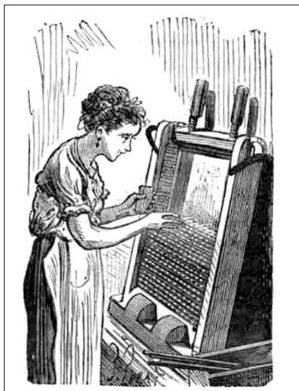
Mise en presse à la main des allumettes chimiques. Figuiet, Louis. « Le phosphore et les allumettes chimiques ». Les merveilles de l'industrie ou description des principales industries modernes ; industries chimiques. Paris : Furne, Jouvet, s.d. [1877] © DR
