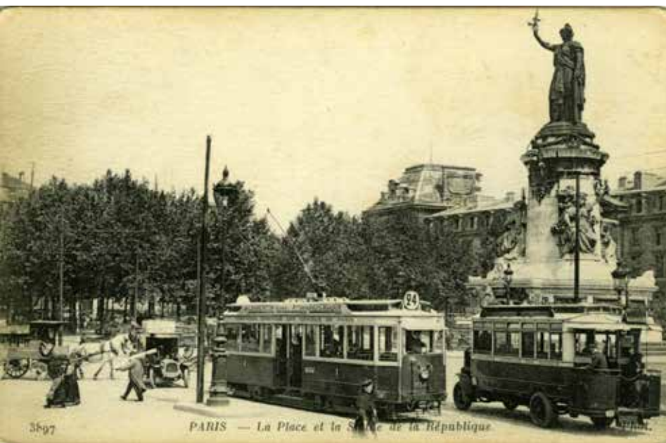
Tramway électrique de type G croisant un autobus Brillé-Schneider PB2, les deux de la Compagnie Générale des Omnibus (CGO) place de la République à Paris en 1913 © Collection AMTUIR - Le Musée des Transports Urbains de France
