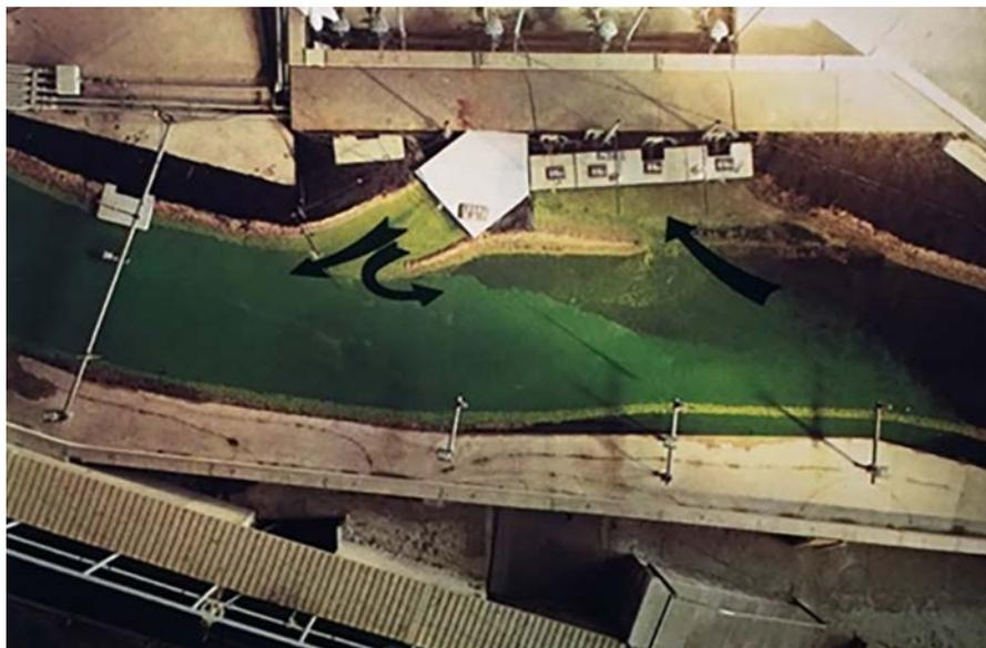
Figure 3. Maquette du site du Bugey au LNH pour étudier les phénomènes de recirculation de l'eau chaude. Source : LNH Informations, n°8, avril 1979, BNF. Ces modèles font plusieurs dizaines de mètres de long (80 m pour celui de la Gironde).
