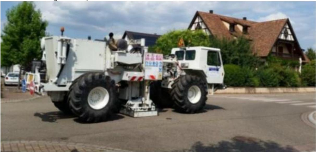
Figure 5 : exemple de camion vibreur (source : dossier)
