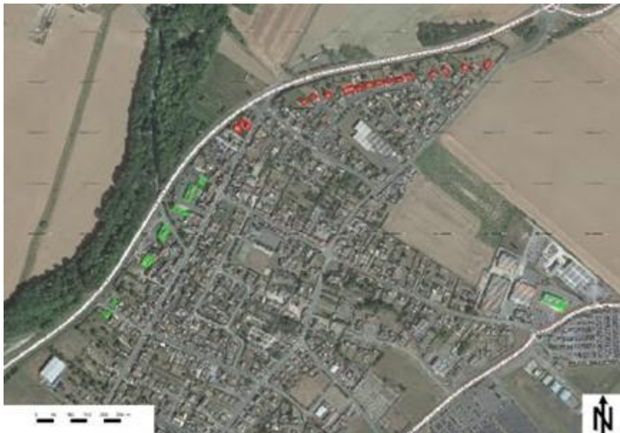
Figure 8 : bâtiments exposés à des augmentations du niveau sonore lié au trafic routier supérieures à 2 dB(A) (en vert ceux inclus dans le périmètre du PGS et en rouge ceux situés en dehors) (source : dossier)
