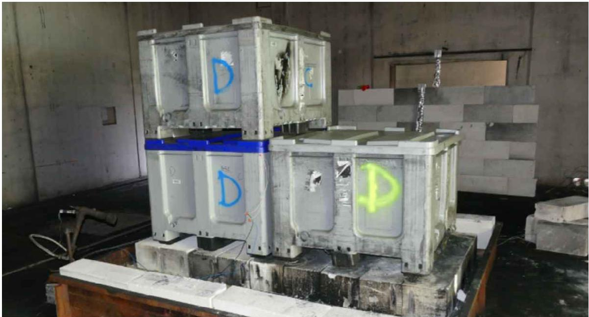
Figure n°13 : positionnement des PALOX dans l'essai n°1 (crédit Ineris)
