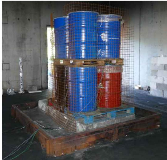
Figure n°14 : positionnement des fûts dans l'essai n°2 (crédit Ineris)
