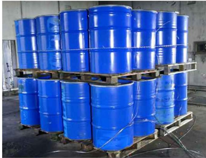
Figure n°16 : configuration de l'essai n°3, 8 palettes de 4 fûts répartis sur 2 étages (crédit Ineris)
