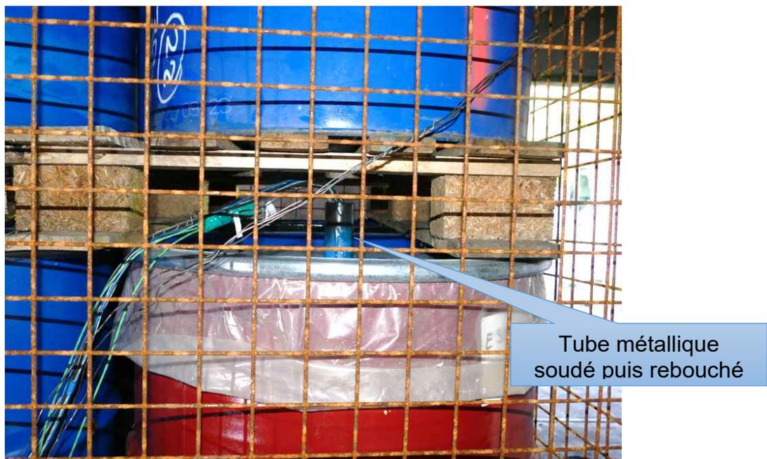
Figure 30: sortie des câbles et thermocouples étanches
