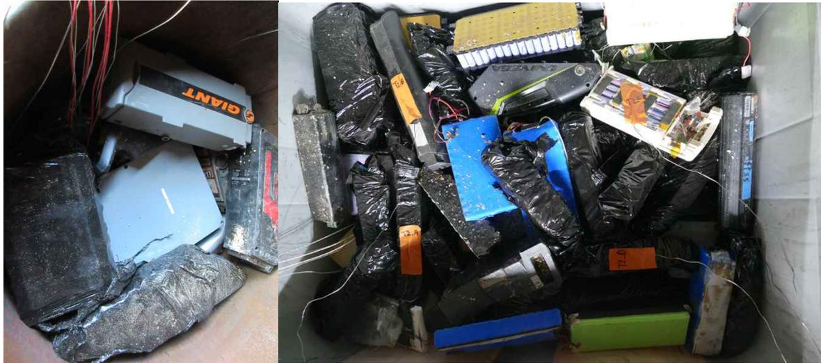
Figure 2: illustration de l'empilement des batteries dans leur fût métallique (gauche) ou leur palox (droite)
