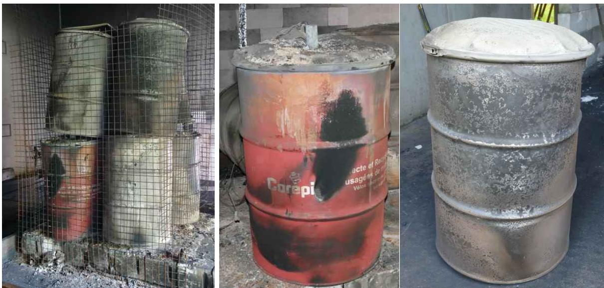
Figure 44 : photo des fûts après essai (gauche : vue globale, centre : fût initialement rempli de batteries, droite : fût vide)
