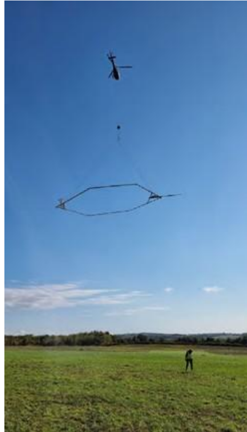
Figure 4 : mesure de résistivité (en haut à gauche), utilisation d'équipements portatifs (en bas à gauche) et levé géophysique en hélicoptère (à droite) (source : dossier)
