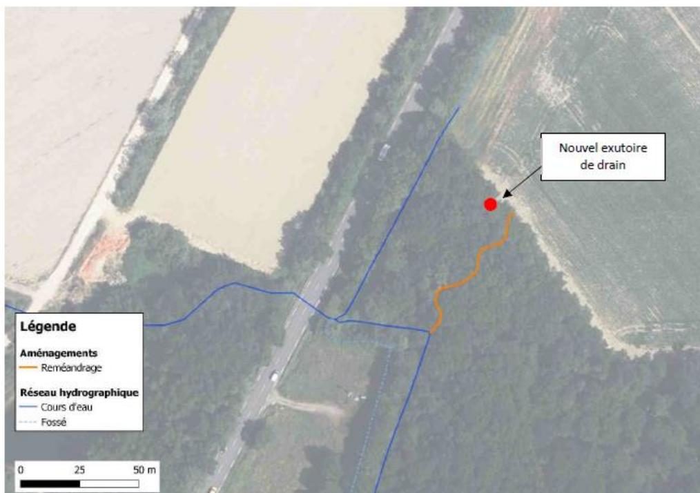
Figure 9 : Projet de réaménagement de la branche nord du ruisseau de la Chaussée (source : dossier)
