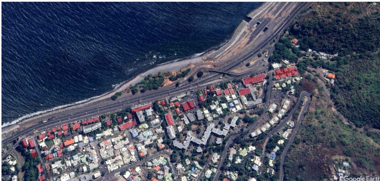
Figure 10 : La Possession, la rue Mondon est parallèle à la 2x2 voies, au sud de celle-ci. En rouge les logements à isoler dans le scénario majorant, sans protection acoustique (source : dossier)
