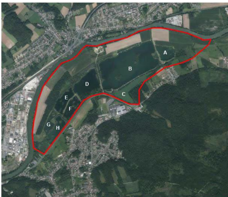
Figure 7 : Vue en plan et mode de fonctionnement du site de compensation de Verneuil-en-Halatte – Source : dossier
