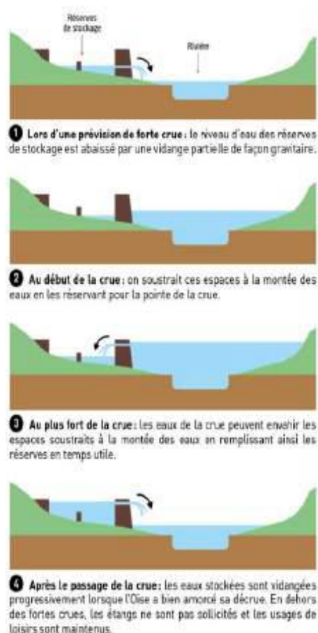
Figure 7 : Vue en plan et mode de fonctionnement du site de compensation de Verneuil-en-Halatte – Source : dossier
