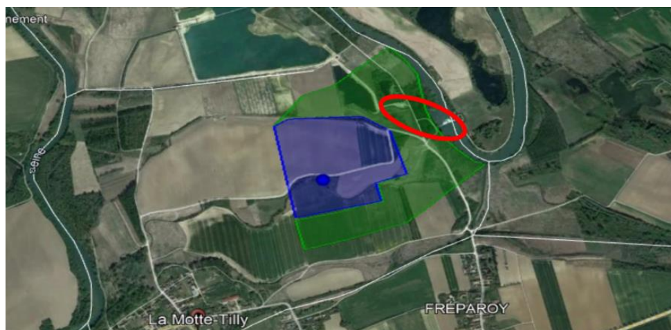
Figure 5 : Localisation du captage (point bleu) et des périmètres de protection rapprochée (en bleu) et éloignée (en vert) du captage de La Motte-Tilly (source : Agence régionale de santé)
