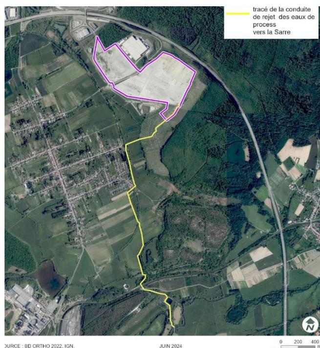
Figure 7 : Schéma du tracé prévu de la conduite de rejet vers la Sarre (source : dossier)
