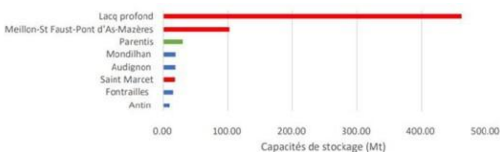
Figure 7 : classement des différentes capacités de stockage de CO 2 du Bassin aquitain (rouge : réservoir déplété de gaz, vert : réservoir déplété de pétrole, bleu : aquifère salin) (source : dossier)
