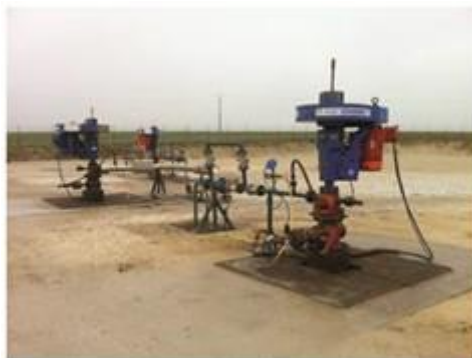
Figure 3 : installation de surface des pompes à cavitation progressive (source : dossier)
