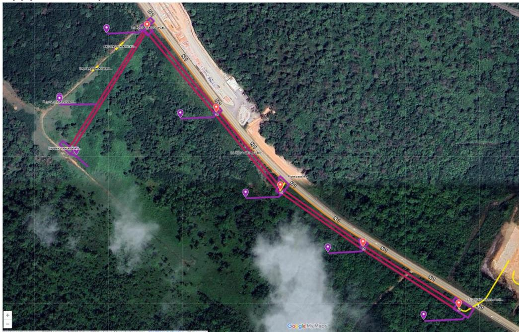
Figure 6 : Raccordement par liaisons aériennes (en rouge) et plateformes de réalisation des pylônes (en violet). Source : dossier
