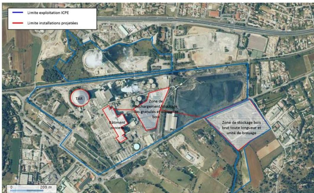
Figure 2 : zones modifiées dans le cadre du projet (TAR : tour aérorefrigérante) (source : dossier)
