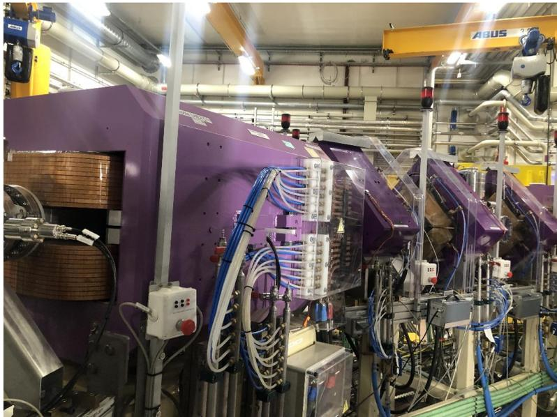
Figure 4 : Vue d'un dispositif de guidage au premier plan et de quadripôles de focalisation au deuxième plan.
