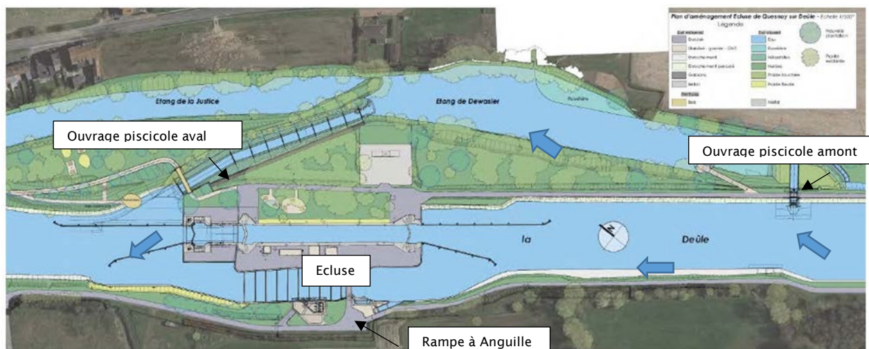
Figure 4 : État final après les travaux et implantation des ouvrages piscicoles (Source : d'après dossier)
