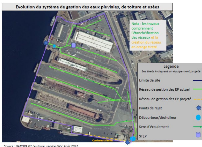
Figure 4 : Évolution de la gestion des eaux pluviales, de toiture et des eaux usées. Source : Haropa Port / Le Havre
