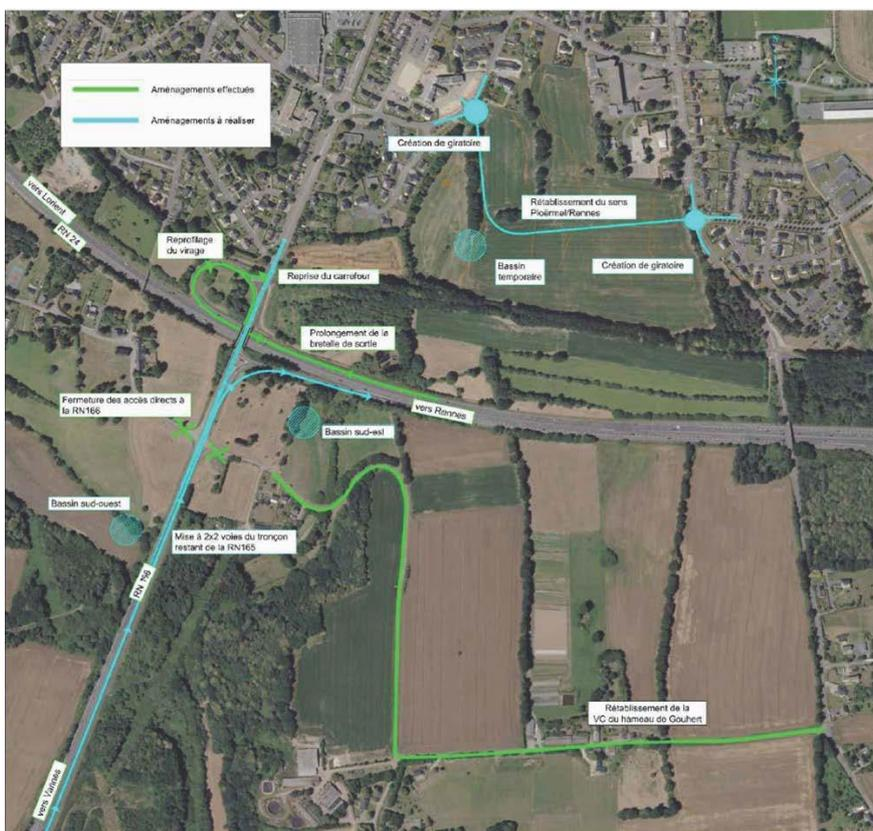
Figure 3 : Plan synoptique des aménagements (Source : dossier).
