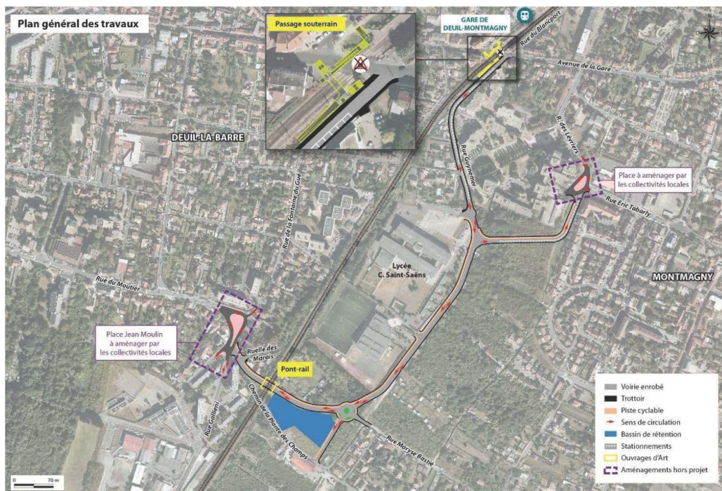
Figure 2 : Suppression du PN n°4 (dans le carré au nord) – plan général des travaux (Source : dossier)
