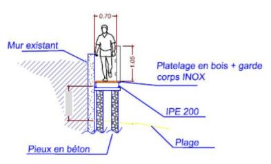
Figure 4 : Tronçon 9–10 avec platelage bois (ou caillebotis métallique) (Source : étude d'impact).
