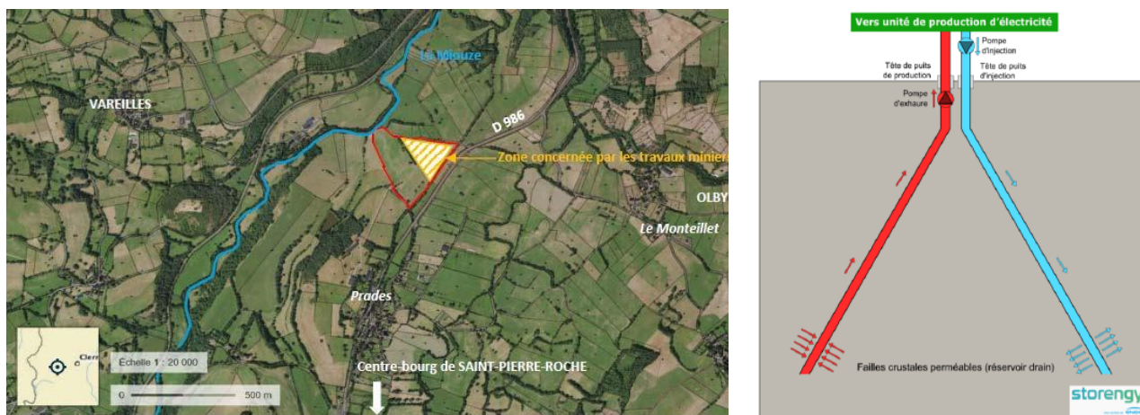
Figure 2 : Localisation du projet et schéma d'un doublet de puits (Source : dossier)
