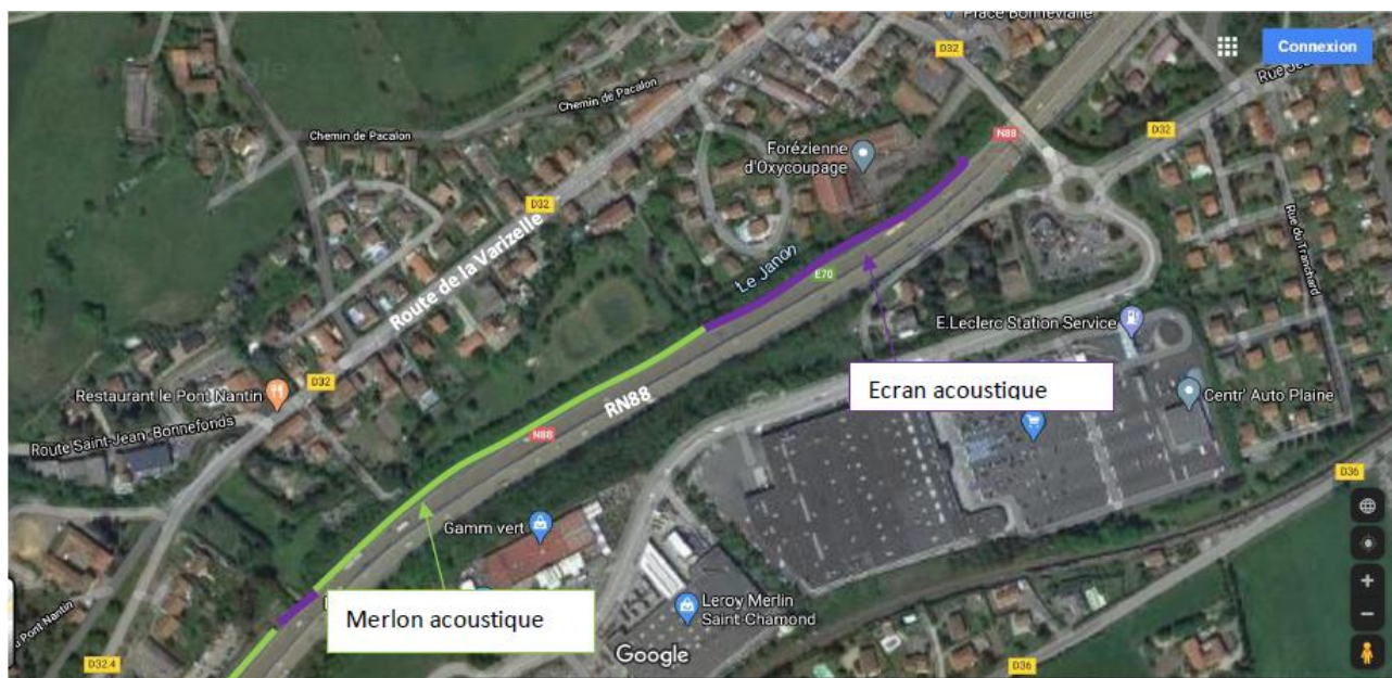
Figure 6 : Localisation des protections acoustiques existantes (Source : Dossier)
