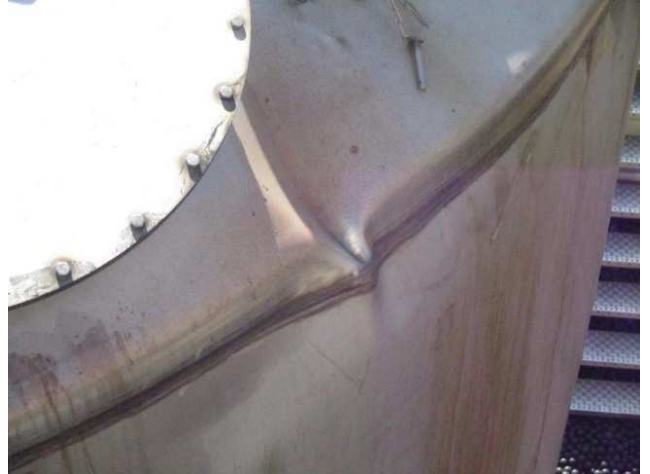
Figure 10 : Endommagement au niveau de la soudure de liaison entre la virole supérieure et le dôme du réservoir (Source DREAL Nouvelle-Aquitaine)
