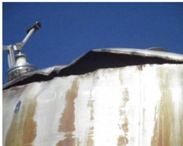
Photo 4 : Déchirure du dôme au niveau de la soudure
