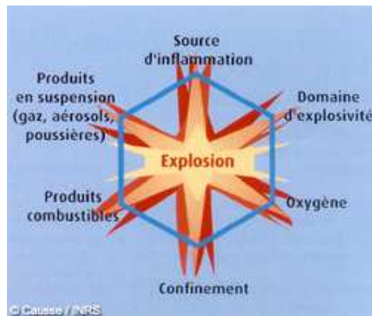
Figure 17: Schéma représentant l'hexagone de l'explosion à l'image du triangle du feu caractérisant la réaction de combustion (Source : INRS)
