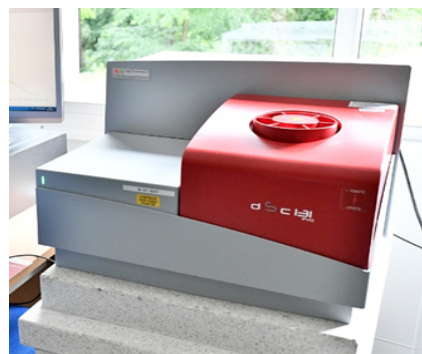
Figure 13. Schéma et photographie du calorimètre à balayage différentiel DSC
