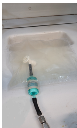
Figure 11. Sac de prélèvement des gaz produits par le mélange d'acides en présence de résine en autoclave
