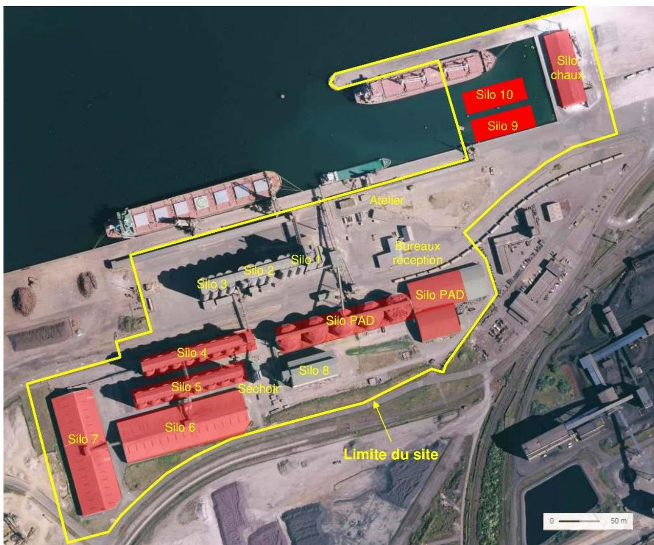
Figure 2 : Plan du projet figurant les deux silos (en rouge vif) construits sur le terre-plein gagné sur la darse. Source dossier.
