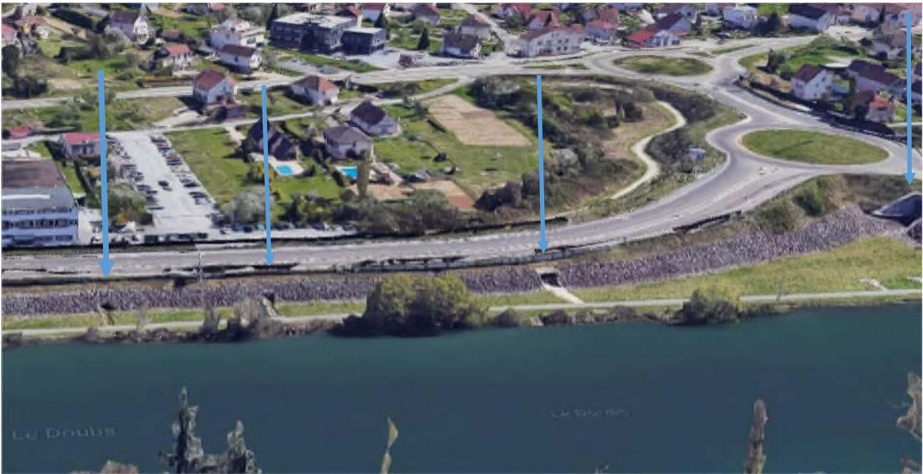
Figure 2 : Ouvrages de décharge (flèches bleues : trois sous le remblai des Mercureaux, un au-delà du giratoire).
