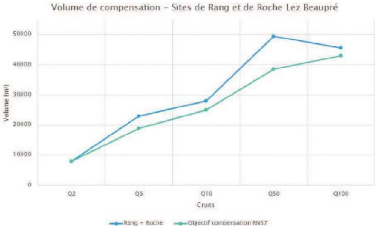
*Figure 7 : Compensation hydraulique cote pour cote assurée par les sites de La Roche-Lez-Beaupré et Rang. Source : dossier.*
