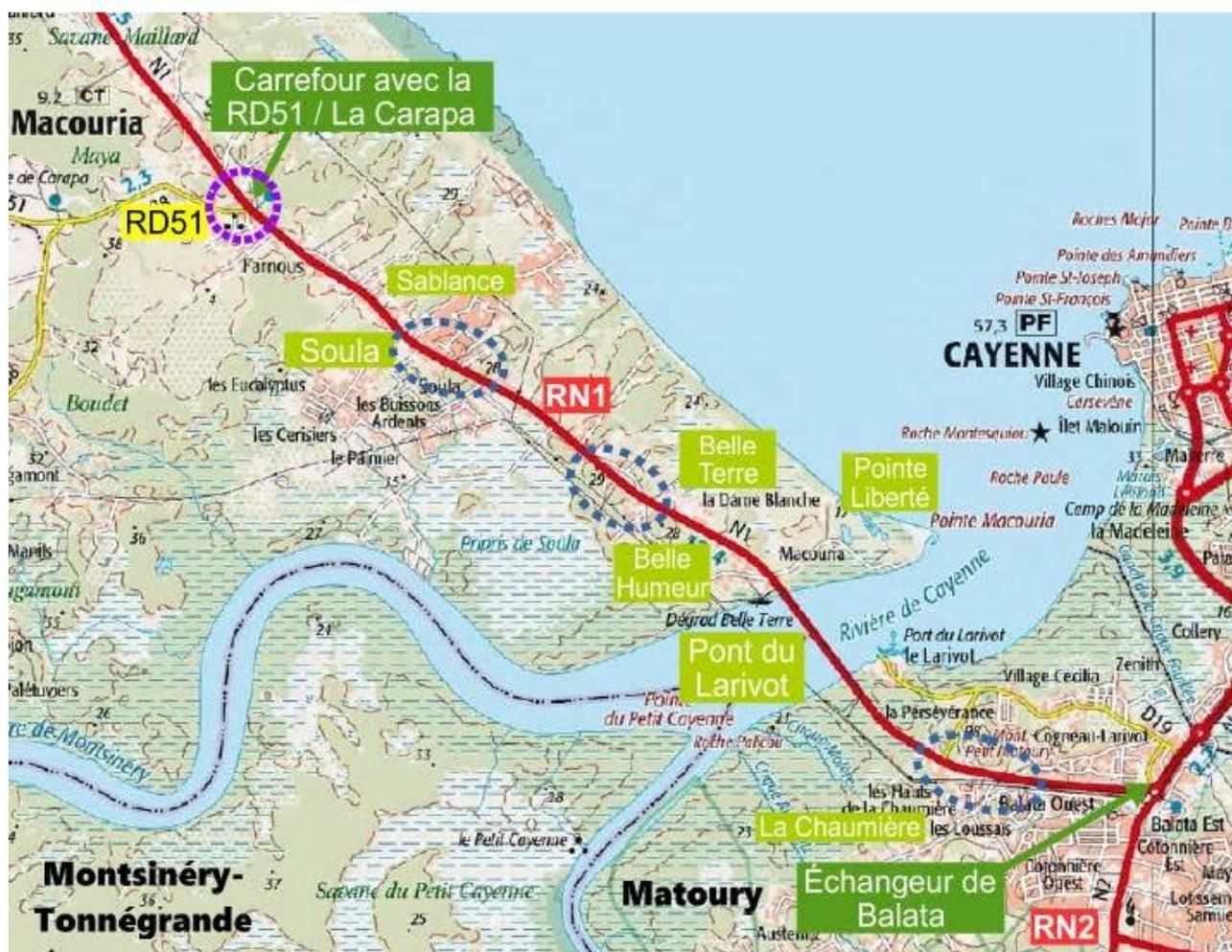
Les 12 km du projet relient l'échangeur de Balata au carrefour de la Carapa incluant le franchissement de la rivière de Cayenne avec la construction d'un deuxième pont dédié au sens de circulation de Cayenne vers Kourou.
