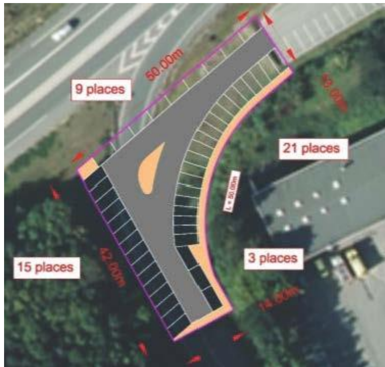
Figure 5 : Extension du parking de covoiturage à Setques (source : dossier)
