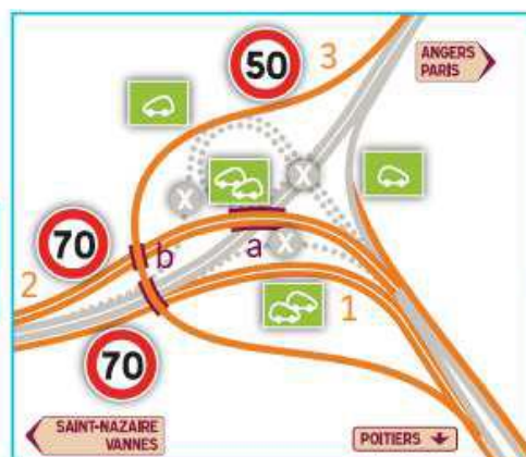
Figure 2 : Variante retenue (D) pour le nouvel échangeur. Source : dossier
