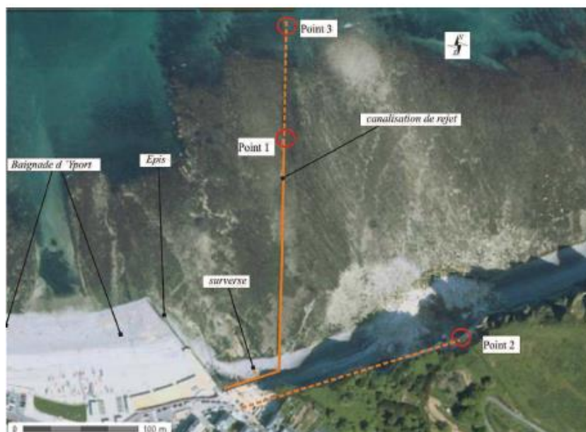
Figure 8 : Points de rejet comparés dans la modélisation – Source : Annexe 5 du dossier
