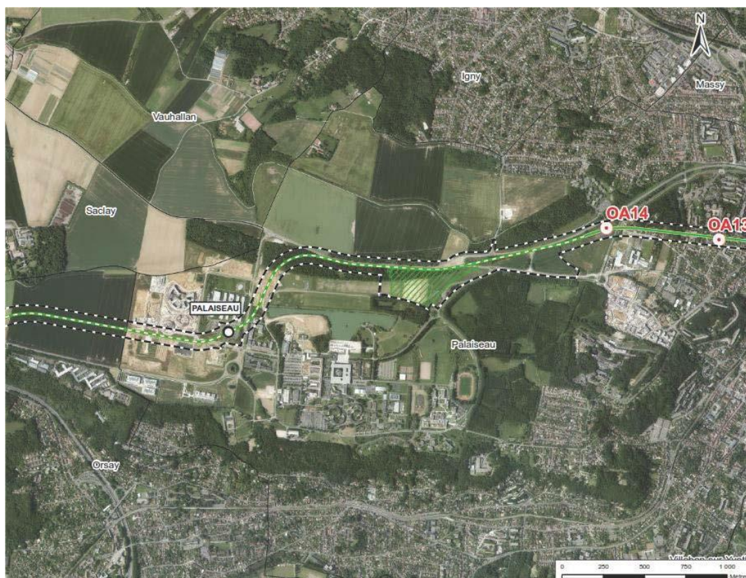
Figure 3 : PGT de la DUP modificative, où les emprises travaux s'élargissent jusqu'à la rigole des Granges (non incluse), l'OA14 est déplacé et le tracé de la rampe et du viaduc est recalé (Source : étude d'impact)
