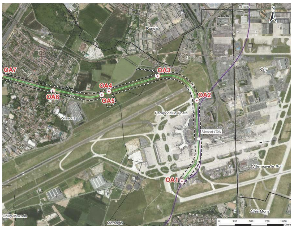
Figure 1 : Plan général de travaux (PGT) de la DUP modificative, avec les ouvrages annexes 4 et 5 déplacés au sud de la route des Avernaises (Source : étude d'impact)
