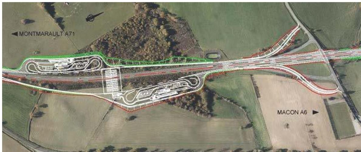
Figure 4 : Le demi-échangeur de Deux-Chaises et sa BPV (source : dossier)
