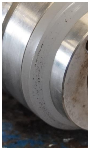
Figure 18 : Joint de la vanne présentant des traces de piqures
