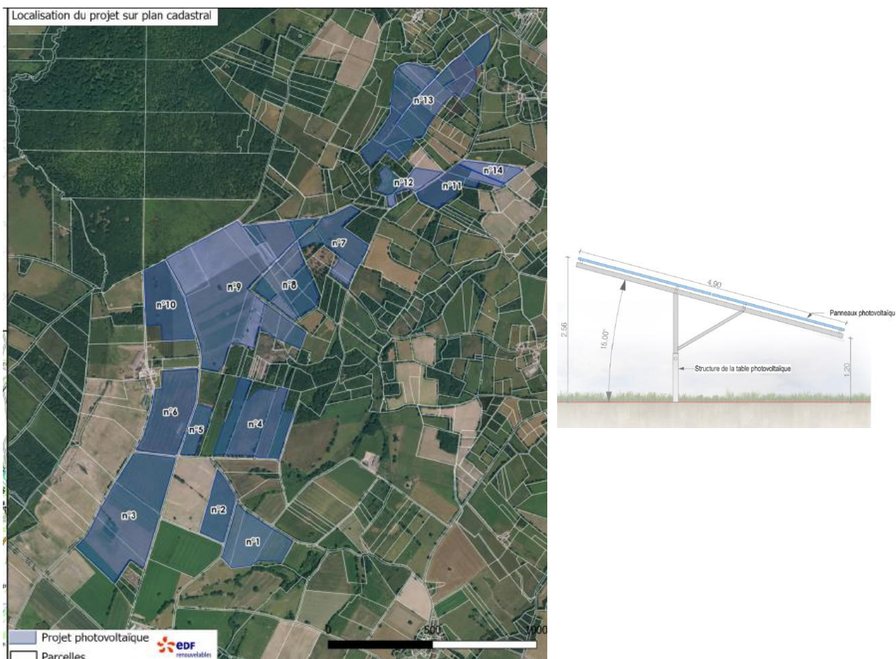
Figure 3 : Localisation du projet (périmètre de 2022) sur le plan cadastral, à gauche et forme des tables, à droite (source : dossier)
